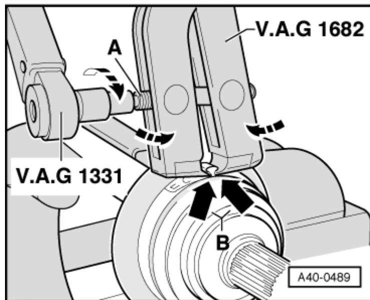
**用弹簧夹钳 -3340- 如图所示安装并紧固贵金属卡箍及凸缘。**
